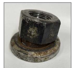
劣化したホイール・ナット
